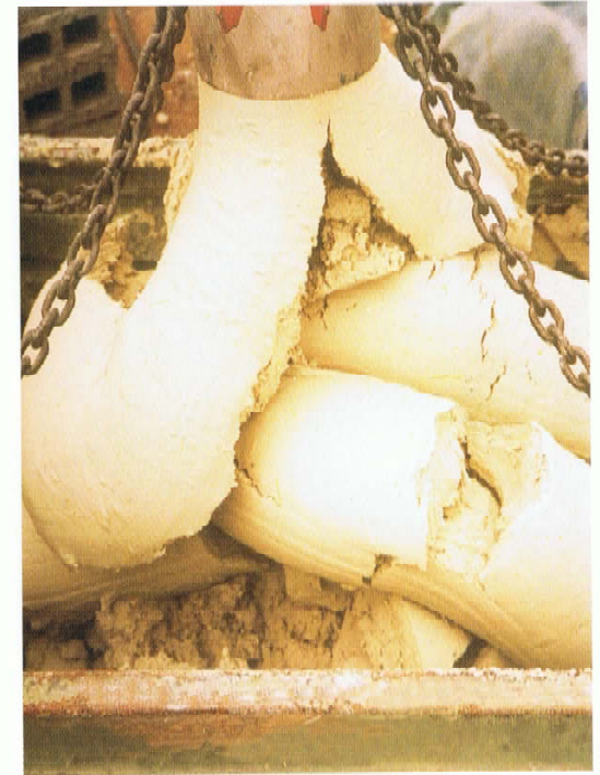
Bleicherde, entwässert, mit 54 % Feststoff
