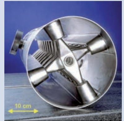
4 Blick ins Innere der supraleitenden CH-Struktur. Die Kavität ist aus dem Element Niob gefertigt und wird zum Betrieb mit flüssigem Helium auf -269 Grad abgekühlt
